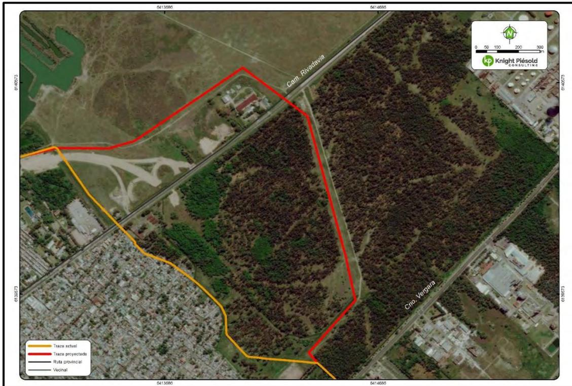
**Ilustración 3-1. Detalle de los caminos de servicio para la línea de alta tensión**
